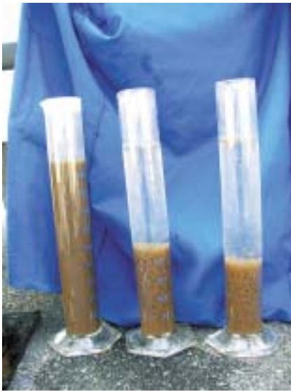
Figure 3 – Tests de décantation en éprouvettes : effet de la dilution (dilutions successives au demi)
