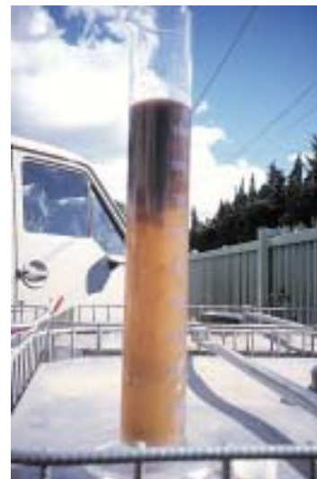
Figure 10 – Test en éprouvette – Remontée de boue
