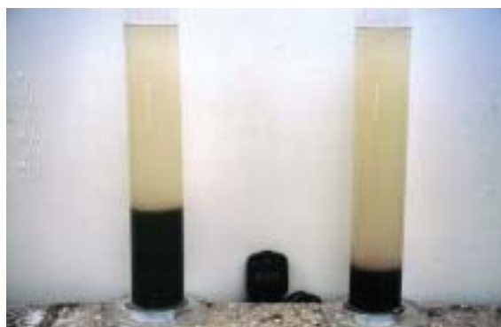
Figure 16 – Test en éprouvettes après 30 mn – eau interstitielle chargée
