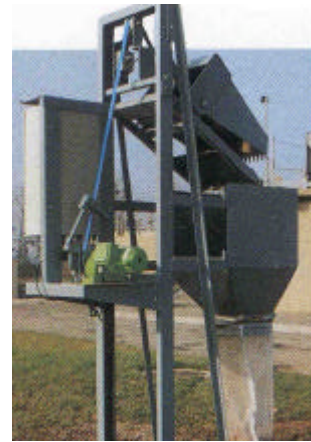
Photo 6 – Dégrillage mécanique – Documentation commerciale FB PROCÉDÉS
